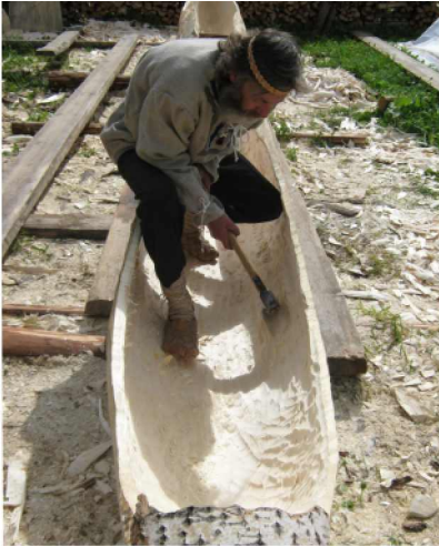
Изготовление лодки-долблёнки. Мастер А.А. Казаков
